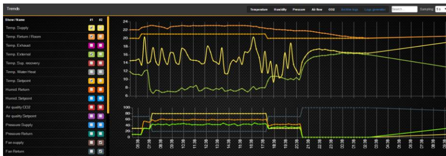
Figure 26 – Окно регистратора данных вентиляционных установок
