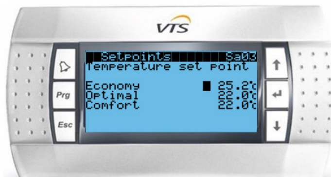
Рис. 38. Настройки температуры воздуха для каждого режима.
