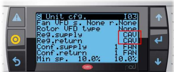
В случае регулирования CAV (для поддержания постоянной мощности) на экране конфигурации вентилятора мы устанавливаем максимальные параметры для данного устройства:
