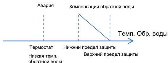
Температура обратной воды: если температура обратной воды имеет слишком низкое значение, устройство ведет себя таким же образом, как и при низкой температуре, полученной от термостата.
