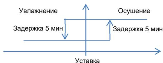
В случае регулирования температуры вытяжки или температуры помещения, приложение проверяет пределы влажности приточного воздуха, чтобы избежать попадания воды в воздуховоды. Чем ближе влажность приточного воздуха к предельному значению, тем ниже будет действовать ПИД-регулятор влажности. В случае регулирования притока запрос влажности поступает непосредственно на устройство.
