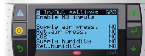
Экран, на котором можно активировать датчики давления / влажности / CO2. Кроме того, мы можем выбрать тип датчика давления на экране G04
