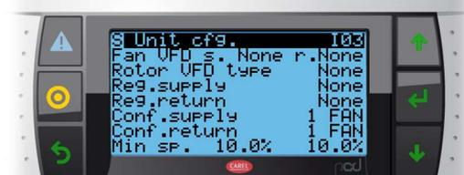
Тип преобразователя частоты (VFD) можно выбрать отдельно для приточного вентилятора, вытяжного вентилятора и роторного теплообменника.
