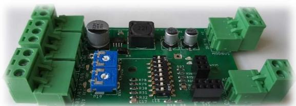
Для правильной работы с контроллером uPC3 необходимо установить DIP-переключатель 8 в положение ON (ВКЛ). Это переключит связь RS-485 на плате PCB-EC с режима Master на режим Slave и плата будет правильно работать с контроллером.
