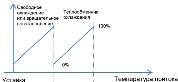
На графике ниже показана последовательность ПИД регулятора в случае нагрева:
