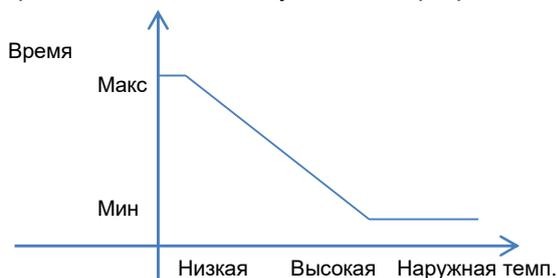
4. Если наружная температура превышает заданное значение защиты от замерзания или после таймера последовательности защиты от замерзания, заслонка может быть открыта.
