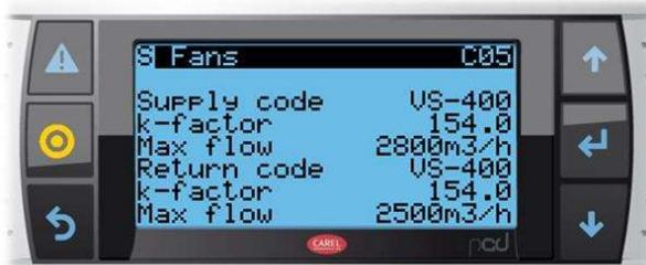
В случае регулирования VAV (для поддержания постоянного давления) на экране конфигурации вентилятора мы устанавливаем максимальные параметры для данного устройства:
