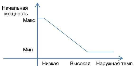
3. Мощность нагрева будет сохраняться в течение определенного времени, определенного следующим графиком
