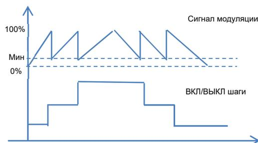
Можно установить разную мощность нагревателей, тогда последовательность включения будет отличаться в зависимости от запроса ПИД-регулятора.
