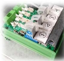
Модуль расширения / Датчики давления
