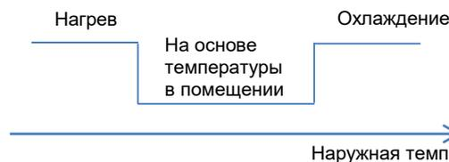
Посередине, между пороговыми значениями температуры нагрева и охлаждения или когда датчик наружной температуры недоступен, режим нагрева или охлаждения будет определяться с учетом температуры в помещении или температуры вытяжного воздуха (если имеются датчики), ниже представлено поведение при температуре в помещении:
